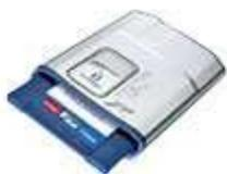
Lançado em 1995, o Zip drive é um dispositivo de armazenamento magnético removível, com grande capacidade de armazenamento e alta velocidade de leitura e escrita (as unidades Zip 750MB superam a maioria das unidades de CD-RW). Há várias opções de discos, com diferentes capacidades de armazenamento (desde 100MB até 750MB).
