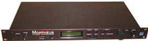
A estrutura das vozes do Morpheus segue o modelo convencional usado pela maioria dos instrumentos sample-players atuais, com um oscilador (que reproduz amostras digitais - waves), um [filtro](#) (que altera a composição harmônica - coloração - do som inicial) e um amplificador (que controla a amplitude dinâmica do timbre). A grande diferença, entretanto, está na forma que o filtro pode atuar sobre o som original, gerado pelo oscilador.
