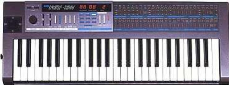
A geração de som nas suas oito vozes, no entanto, era feita por contadores digitais (designados como DCO – Digital Controlled Oscillator), com o processamento analógico feito por chips dedicados. A implementação de sintetizadores com circuitos analógicos foi ficando cada vez mais complicada e cara à medida que os músicos exigiam mais polifonia, o que requeria circuitos extras com VCOs, VCFs e
