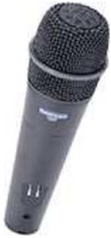
O **microfone dinâmico** consiste de um diafragma fino acoplado a uma bobina móvel dentro de um campo magnético. Quando o som atinge o diafragma, este move-se para dentro e para fora, e este movimento da bobina dentro de um campo magnético produz uma variação de corrente na bobina (e conseqüentemente uma variação de tensão em seus terminais) análoga à variação da pressão atuando no diafragma.
