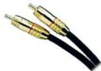
O formato S/PDIF suporta dois canais (stereo) e pode ser implementado por conexão elétrica ou óptica. Na conexão elétrica são usados plugs do tipo RCA, não-balanceados, e cabos de impedância de 75 ohms (ex: cabos de vídeo de boa qualidade). Na conexão óptica são usados plugs do tipo TosLink (ou miniplug óptico) e cabos de fibra óptica. Em ambos os casos, um mesmo cabo transfere os dois canais do stereo.
