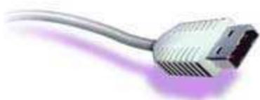
O USB (Universal Serial Bus) é um padrão de interconexão de equipamentos ao computador, e transfere os dados digitais de forma serial, bidirecionalmente. Através da conexão USB, pode-se acoplar ao computador scanners, impressoras, interfaces MIDI, interfaces para jogos, etc).
