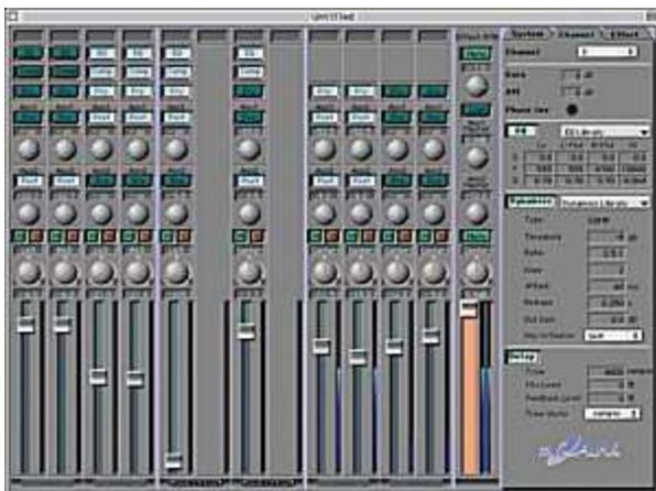
Usando o software de roteamento fornecido com todos os produtos Yamaha que suportam mLAN é possível reconfigurar facilmente todo o sistema - conectando e desconectando dispositivos à vontade - sem ter que plugar ou desplugar fisicamente ou redirecionar qualquer cabo.
