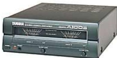
É um amplificador sem pré, só com o estágio de potência. Normalmente é usado em sistemas de sonorização de show (P.A. e amplificação de palco), e também em estúdios. Nesses amplificadores, só há o controle de volume de cada canal, pois o sinal já vem em nível adequado ("line"). Os amplificadores para sonorização (ex: Yamaha P3500) têm que ter muita potência, e normalmente são usados em grupos. Os amplificadores
